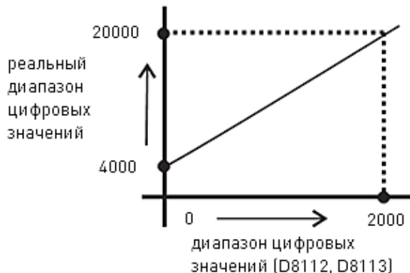
Рис. 5. Зависимость преобразования и сохранения значений аналогового входа в цифровые данные с сохранением в регистры D8112, D8113
