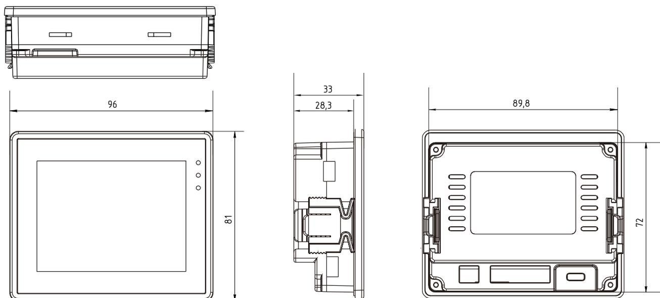
Рисунок 1 - Габаритные размеры модуля.
