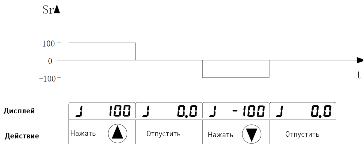
Рис. 29. Отображение и действия во время выполнения ручных перемещений
