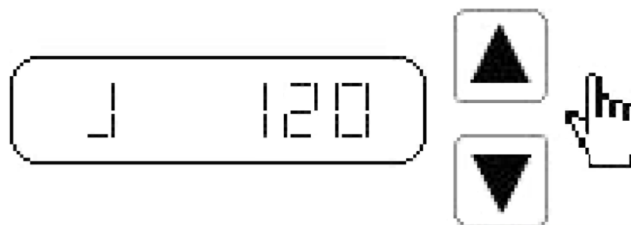
Рис. 27. Настройка скорости двигателя в режиме ручного запуска без нагрузки
