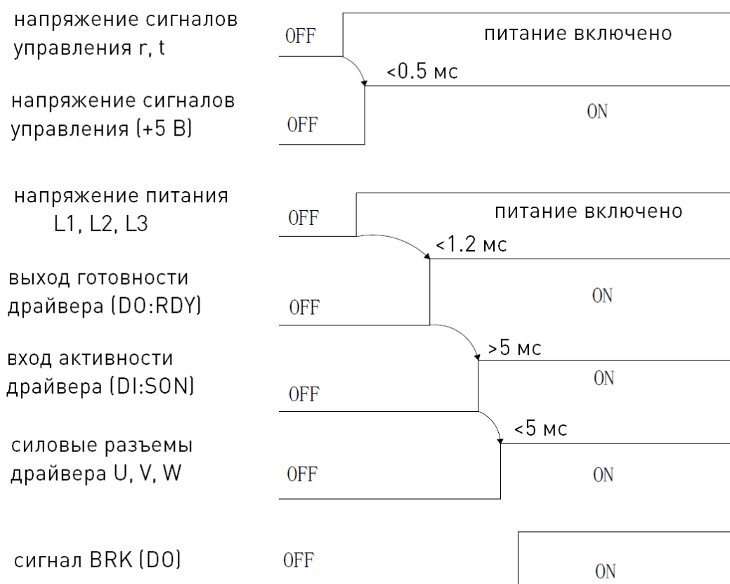
Рис. 39. Последовательность подачи сигналов управления и напряжения питания
