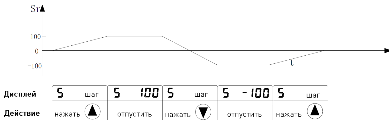
Рис. 30. Отображение и действия во время выполнения настройки скорости
