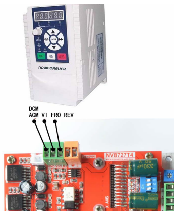
Рис. 2.3 Выход управления шпинделем и подключение инвертора
