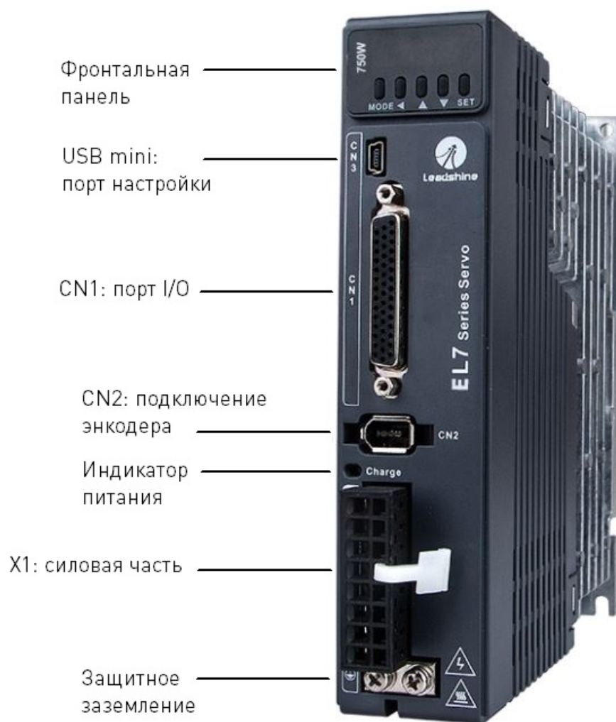
Рисунок 3 – Схема расположения основных портов подключения (EL7-DxxxZ).
