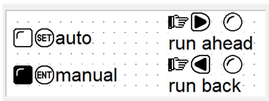
Теперь оборудование находится в ручном режиме. Нажмите клавишу «SET» для перевода оборудования в автоматический режим, что переведет реле M10 ПЛК в положение ON.
