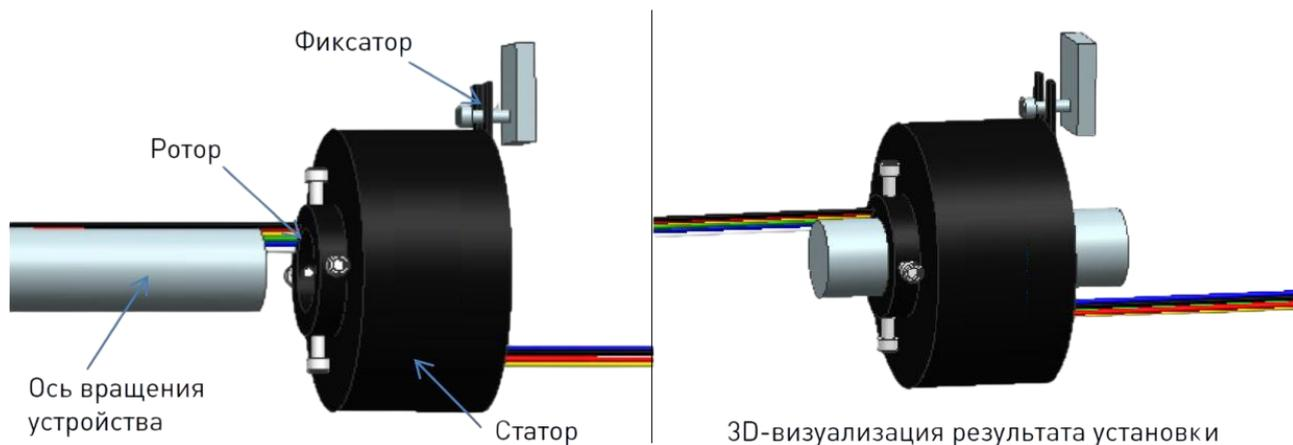
Рисунок 2 – Установка вращающегося электрического соединения серии GK.
