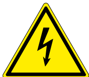
Рисунок 13 — Опасность поражения электрическим током.
