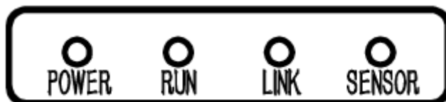
Рисунок 6 – Расположение индикаторов на лазерных головках BS06K, BS12K, BS20K (слева направо).
